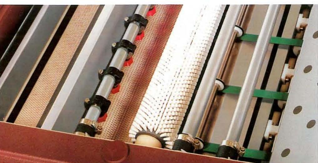
Walzenbürsten sind in Offsetdruckplatten-Entwicklungsmaschinen unentbehrlich.
