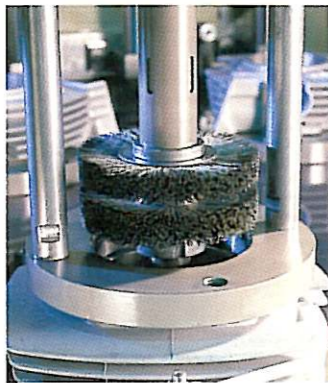
Zwei Alpha Einzel-scheiben-Bürsten honen einen Zylinderkopf.
