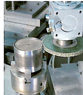
Entzunder eines Filtergehäuses mit der kunststoffgebundenen Delta Einzel-scheiben-Bürste.
