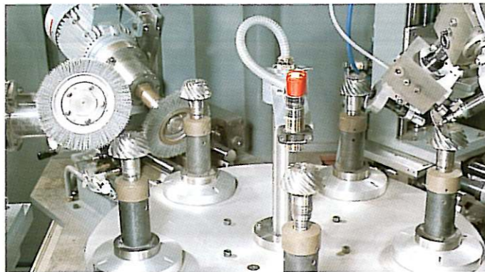
Eine Rundtisch-Entgratmaschine mit zwei Vorschleif- und zwei Bürstenstationen.
