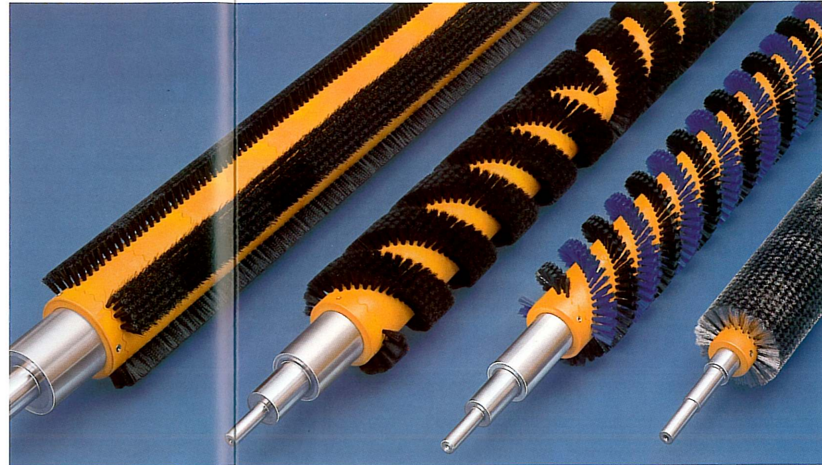
Beispiele für Besatzanordnungen (von links nach rechts): Linearbesatz, Spiralbesatz mit Rechts/Links-Steigung, Spiralbesatz und Vollbesatz.
