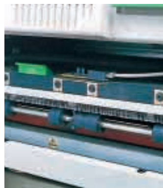
Nachdem Ihre Kopie auf dem Blatt steht, nehmen unsere Bürsten die Ladung ab.
