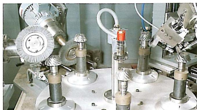
Une ébarbeuse à table circulaire disposant de deux stations de dégrossissage et de deux stations de brossage.
