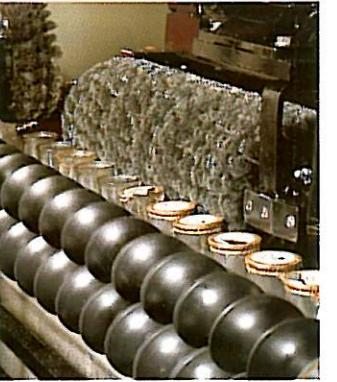
**Bürstentechnik im Recycling: z. B. beim Abtrennen der Deckel von Aludosen.**
