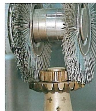
Deux brosses monodisques Alpha opèrent la finition d'une culasse de cylindre.
