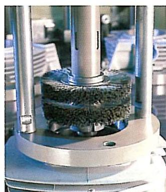
Zwei Alpha Einzelscheiben-Bürsten honnen einen Zylinderkopf.
