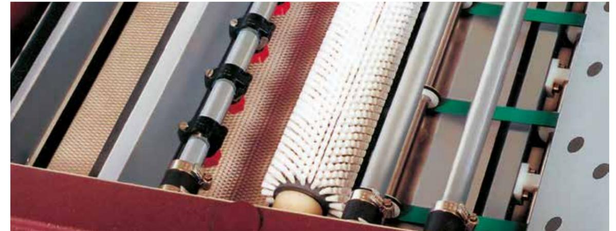
Walzbürsten sind in Offsetdruckplatten-Entwicklungsmaschinen unentbehrlich.
