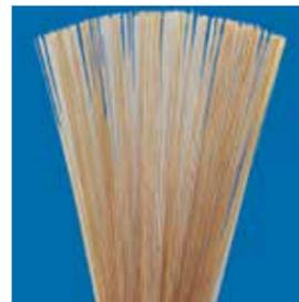
HCB ist nicht brennbar, verfügt über eine sehr gute Steifigkeit, hohe Spannkraft, Elastizität und Abriebfestigkeit. Spezifisches Gewicht 1,32 g/cm<sup>3</sup>.
